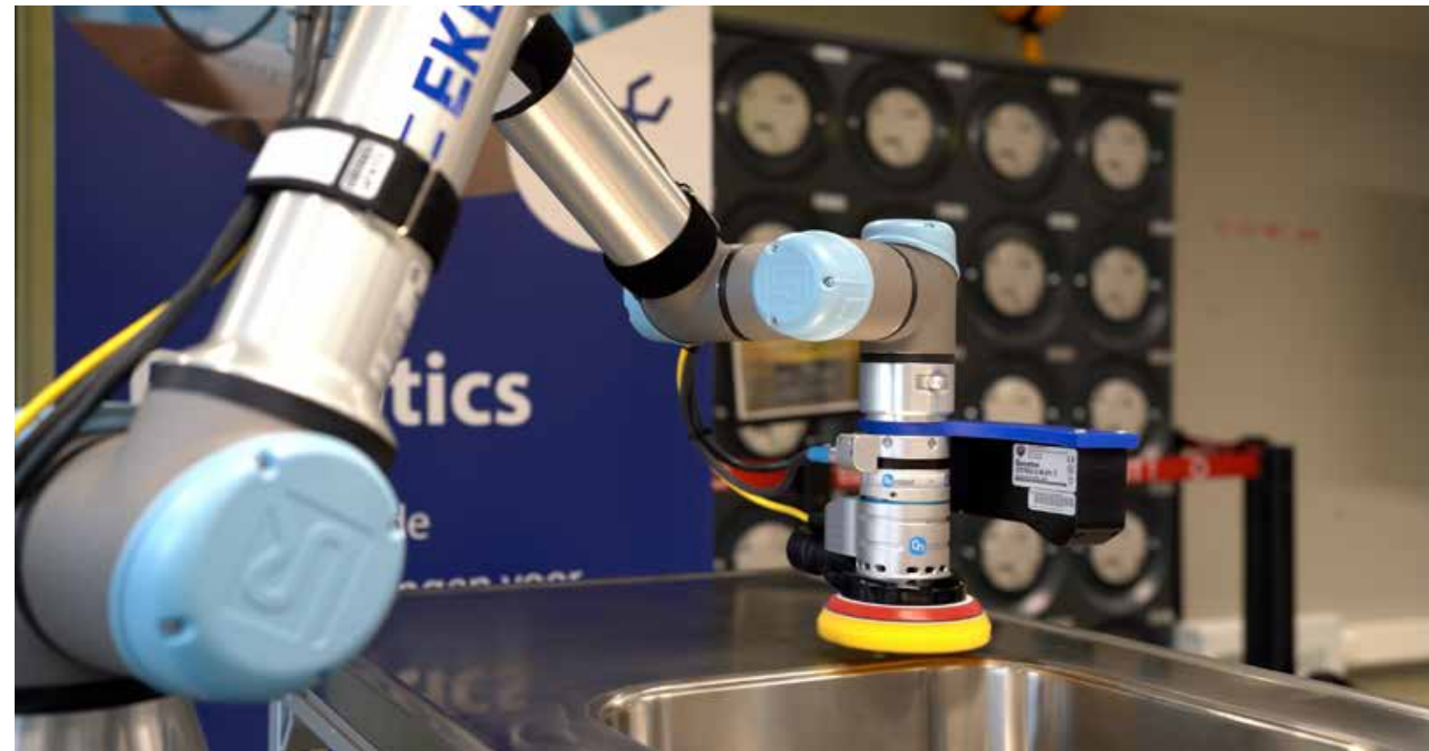
Automatisch schuren en polijsten: sneller, mensarm, hogere en constantere kwaliteit, veiliger en ergonomischer.
