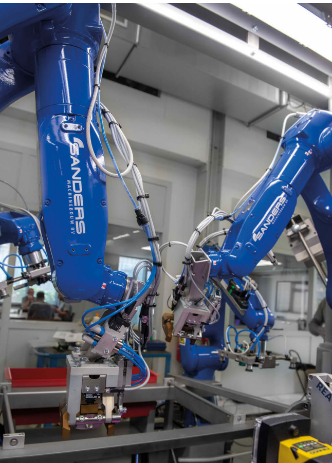
De cel is uitgerust met vier Yaskawa robots met FSU (Functional Safety Unit). Rechts onder is hier één van de twee Cognex camera's te zien (geel/zwart) alsmede de rode afleg bak voor foutieve producten.
