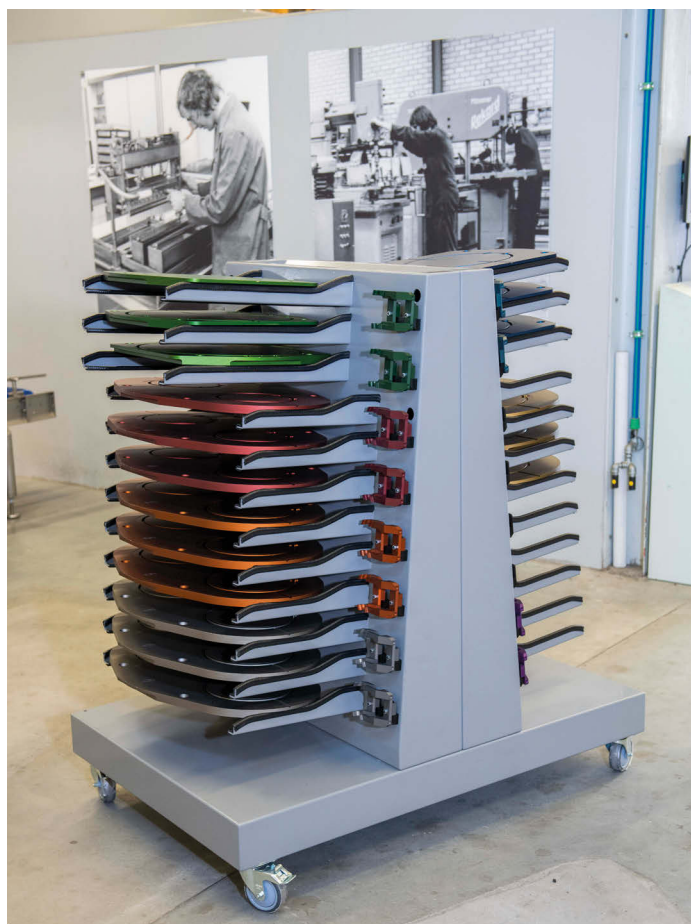
Trolley met daarop de verschillende formaatdelen. Elke set formaatdelen bestaat uit een plaat en twee grippers die qua kleur zijn gepaard. Momenteel zijn er acht sets formaatdelen. Per set kan een specifiek type seal worden verwerkt (dus totaal 8 verschillende seals). Het systeem is uit te bereiden voor de verwerking van meerdere seal-typen.
