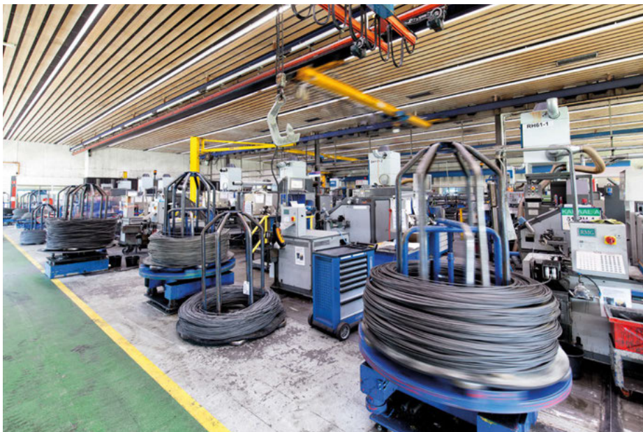
De lagerrollen worden bij TN vervaardigd uit gewalste/getrokken draad dat in rollen wordt aangeleverd. In de eerste fase van het productieproces wordt de draad door een treksteen getrokken om hem iets dunner en rechter te maken.
