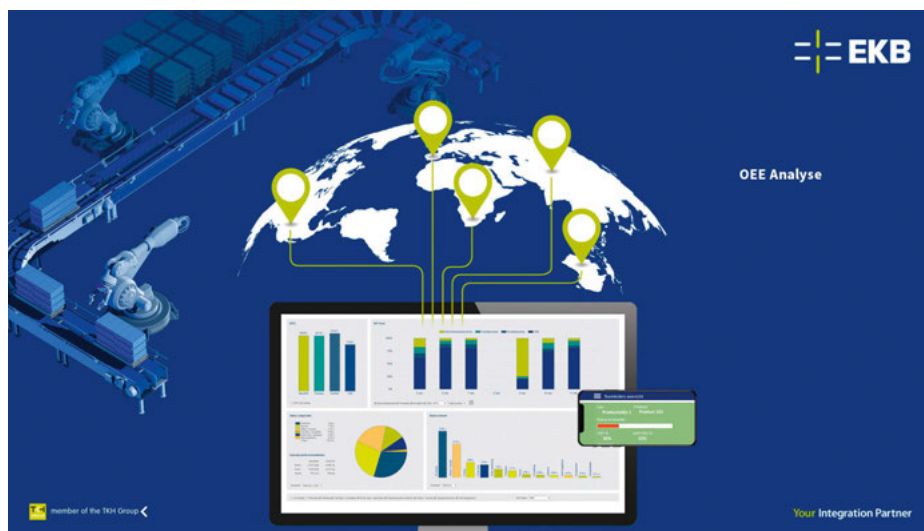
De Overall Equipment Effectiveness (OEE) is een belangrijk percentage dat aangeeft hoe efficiënt een productie-installatie is. Door de OEE-waarde te vergelijken met soortgelijke installaties en/of door het OEE-verloop bijvoorbeeld per week of maand te monitoren, krijgt men een goed beeld van het prestatieniveau.
