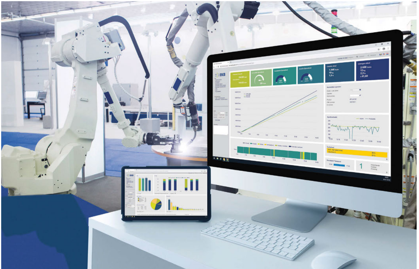
Via web-based dashboards kunnen gegevens worden gepresenteerd over machinebezettingen, productkwaliteiten, energiegebruik, afkeur, grondstofverbruik, stilstand door onderhoud, etc.
