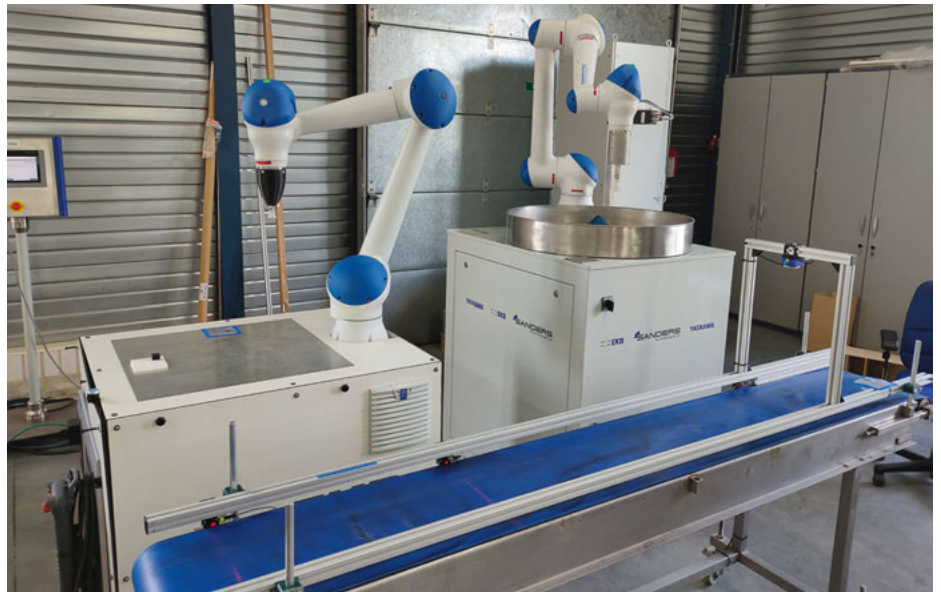
Door EKB gebouwde controlelijn met twee Yaskawa cobots en verschillende visionsystemen. Indien deze constateren dat het product niet correct is, wordt dit door de tweede robot van de band gehaald en op een werktafel gelegd.
