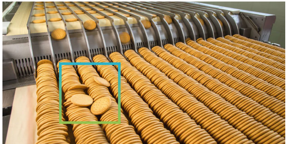
Met vision wordt in deze koekjesfabriek gecontroleerd of de koekjes keurig naast elkaar liggen en klaar zijn voor verpakking. Foute situaties worden onmiddellijk gedetecteerd.
