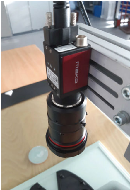
Een vision systeem is opgebouwd uit een camera met lens en een belichtingssysteem. De camera's van Mako zijn er in resoluties van 0,3 tot 31 Megapixels.
