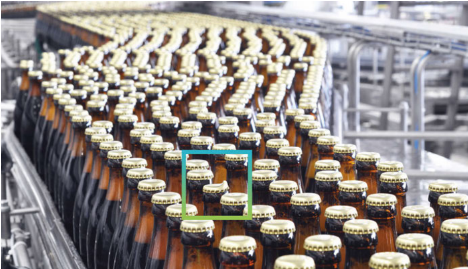
Met machine vision kan in een razend tempo worden gecontroleerd of kroonkurken goed op flesjes zijn aangebracht.
