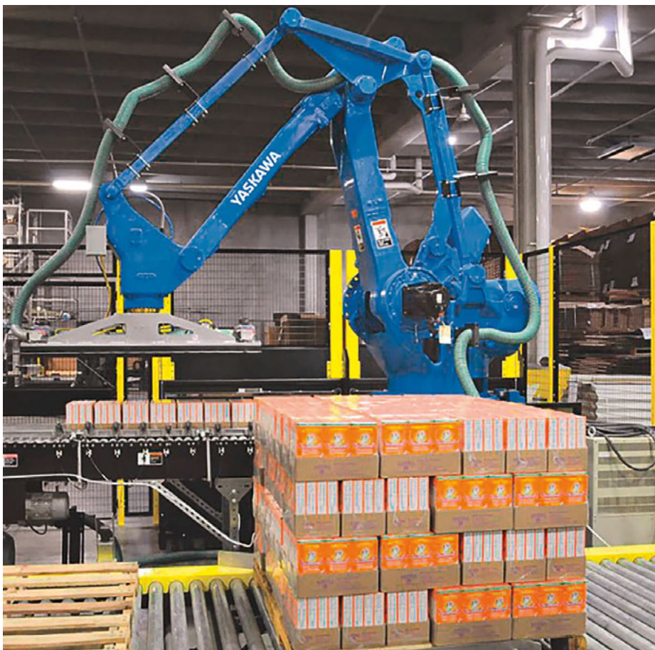
Deze industriële robot doet zijn werk in een volledig met hekken omgeven ruimte wat een van de veiligste oplossingen is.
