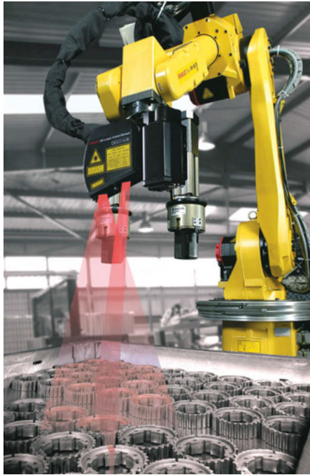
Een Fanuc robot met 3D Laser Vision is in staat om willekeurig in een bak gepositioneerde producten te herkennen en op te pakken.
