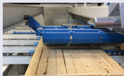
Veegmachine aan het werk om de tussenliggers weg te veegen
