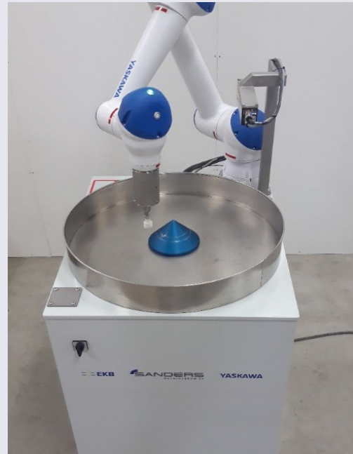
Yaskawa HC 10 cobot met 'circular line tracking' en vision met LMI Gocator 3D laser line scanner.
